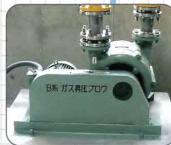
ガス昇圧ブロウ
